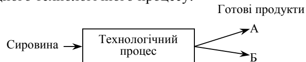
Рис. 5.3. Схема виробництва із спільним для всіх продуктів технологічним процесом
